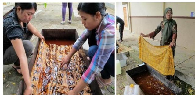
**Gambar 10.** Proses Pencelupan Warna Alam dan Sintetis Pada Kain Panjang
