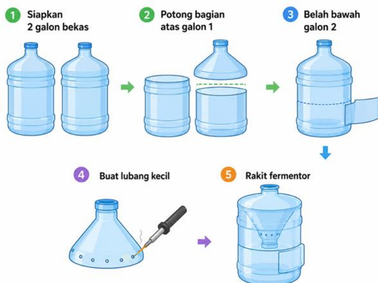
Gambar 3. Tahapan pembuatan fermentor MOL menggunakan galon bekas
