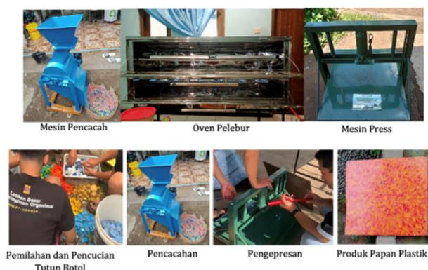
Gambar 6. Teknologi Pengolahan Tutup Botol Menjadi Papan Plastik (atas) dan Proses Pembuatan Papan Plastik (bawah)
